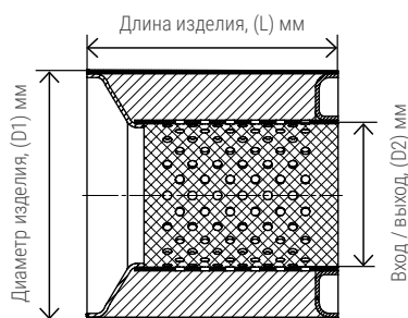
Чертеж пламегасителя коллекторного с перфорированной трубой
